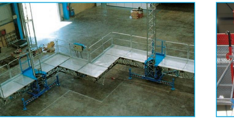
Configuración en ángulo / Angle arrangement / Configuration en angle
